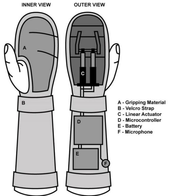
Fig. 11.1. Glove Diagram.
