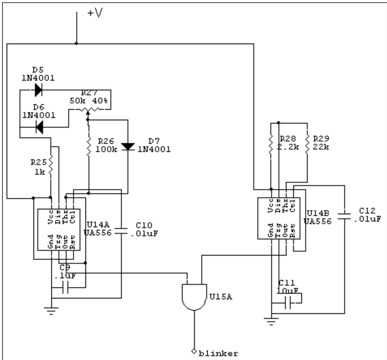
Fig. 20.4. Light Control Circuit.
