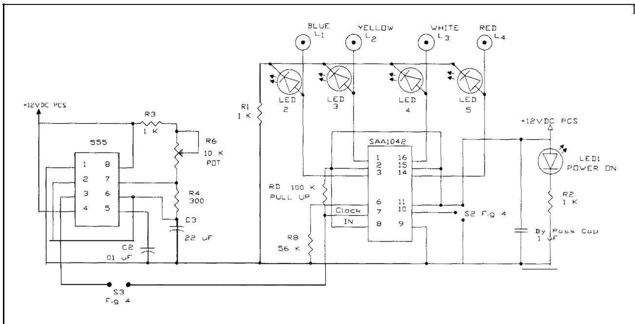
Fig. 5.10. Stepper Motor Circuit Diagram.
